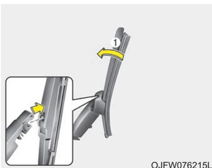
1. Поднимите рычаг стеклоочистителя и извлеките узел щетки.
