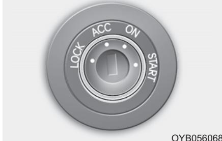
Рулевое колесо блокируется для защиты от угона. Ключ из замка зажигания можно извлечь только в положении «LOCK» (Заблокировано).
