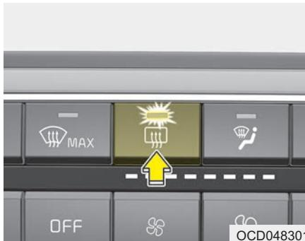
Обогреватель заднего стекла предназначен для обогрева и удаления запотевания, инея или тонкого слоя льда с заднего стекла.
