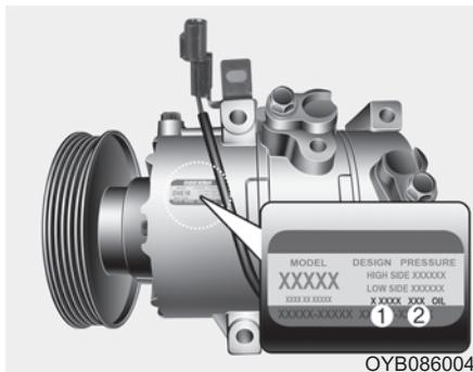
Табличка компрессора содержит сведения о типе компрессора, которым оснащен автомобиль, в частности модель, номер по каталогу поставщика, серийный номер, хладагент (1) и компрессорное масло (2).
