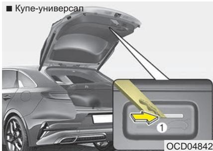
Автомобиль оснащен устройством аварийного открытия двери багажного отделения, которое находится в ее нижней части.
