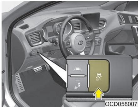
Система электронного контроля устойчивости (ESC) предназначена для стабилизации автомобиля во время выполнения маневров поворота. Система ESC проверяет направление, в котором поворачивается рулевое колесо, и направление, в котором автомобиль движется на самом деле.
