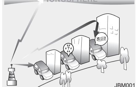
Передачу радиосигналов в диапазонах AM и FM осуществляют ретрансляционные вышки, расположенные вокруг населенных пунктов. Эти сигналы принимаются радиоантенной автомобиля. После этого сигнал поступает на радиоустройство и передается на колонки автомобиля.
