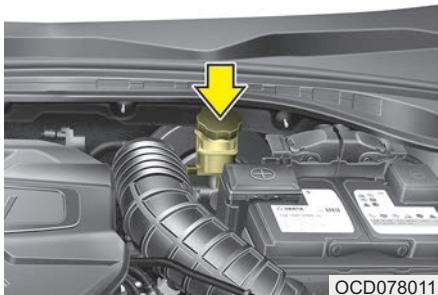
Периодически проверяйте уровень жидкости в бачке. Уровень жидкости должен находиться в пределах между отметками «MAX» (Макс.) и «MIN» (Мин.), нанесенными на боковой части бачка.
