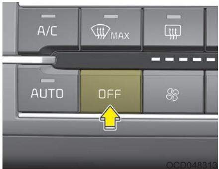
Нажмите на кнопку выключения, чтобы отключить переднюю систему климат-контроля. Однако вы можете по-прежнему работать с кнопками выбора режима и забора воздуха, пока выключатель зажигания находится в положении «ON» (Вкл.).
