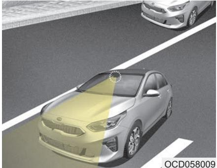
Система контроля полосы предназначена для удержания автомобиля по центру выбранной полосы движения с помощью передней камеры, установленной сверху на лобовом стекле. Она активируется только в сочетании с функцией интеллектуального круиз-контроля и помогает водителю контролировать продольное и поперечное перемещение автомобиля.
