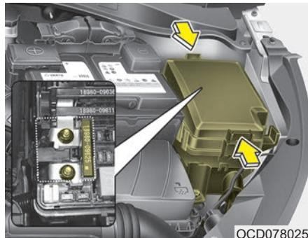
Если основной предохранитель перегорел, его следует извлечь следующим образом:
