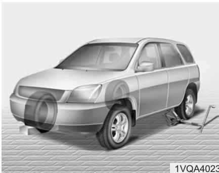
4. Достаньте колесный гаечный ключ, домкрат, рукоятку домкрата и запасное колесо из автомобиля.
