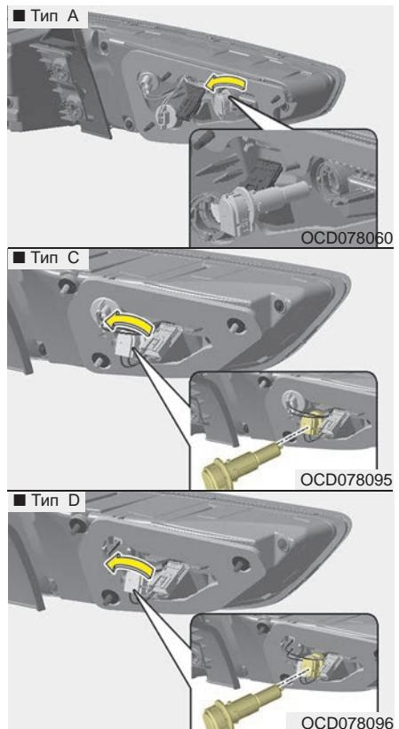
3. Извлеките патрон, поворачивая его против часовой стрелки до тех пор, пока выступы на патроне не совпадут с прорезями на узле.
