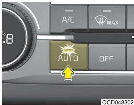
1. Нажмите кнопку «AUTO» (Автоматический режим). Управление режимами работы, скоростью вращения вентилятора, режимом подачи воздуха и работой системы кондиционирования будет осуществляться автоматически в соответствии с заданным значением температуры.
