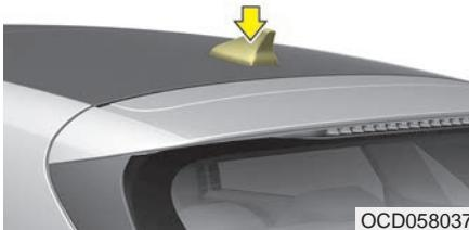
Ваш автомобиль оснащен антенной на крыше для приема сигналов радиостанций на частотах AM и FM.
