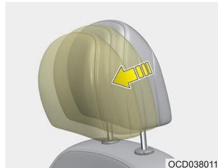
Передвинув подголовник вперед, его можно установить в одно из четырех фиксированных положений. Чтобы установить подголовник в крайнее заднее положение, потяните его полностью вперед в самое дальнее положение и отпустите его. Отрегулируйте подголовник так, чтобы он правильно поддерживал голову и шею.
