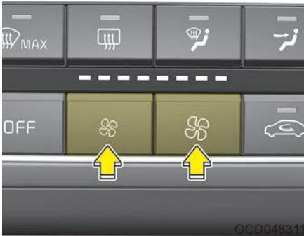
Скорость вентилятора можно установить с помощью регулятора скорости вращения.
