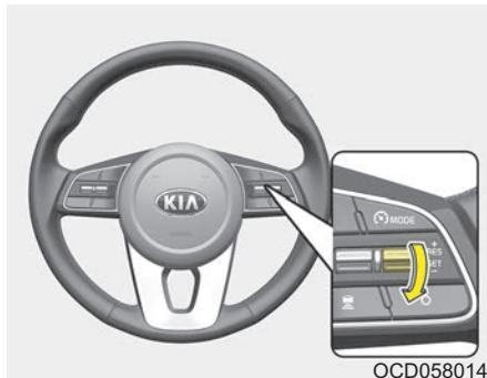
1. Для включения системы нажмите кнопку «CRUISE» (Круиз-контроль). Загорится индикатор «CRUISE» на комбинации приборов.
