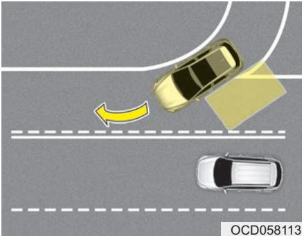
Системы предупреждения об опасности столкновения в слепой зоне BCW могут не работать надлежащим образом при езде по извилистым дорогам. В определенных ситуациях система может распознавать автомобиль, движущийся в той же полосе, что и ваш автомобиль.
