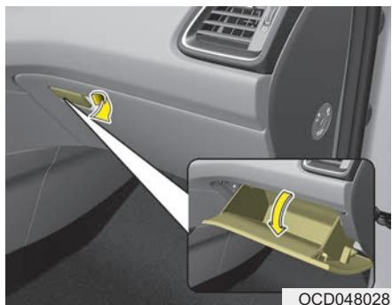
Чтобы открыть перчаточный ящик, потяните за ручку, после чего перчаточный ящик откроется автоматически. Закройте перчаточный ящик после использования.
