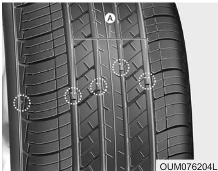
При чрезмерном износе шины индикатор износа (A) приобретает вид сплошной полосы. Это значит, что оставшаяся толщина протектора нашине составляет менее 1,6 мм. В этом случае заменитешину.
