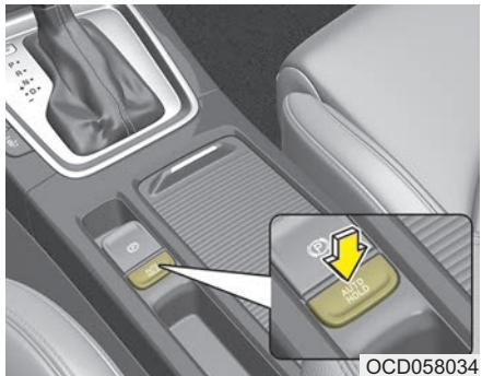
1. Закройте дверь водителя, капот и дверь багажного отделения, пристегните ремень безопасности или нажмите педаль тормоза, после чего нажмите кнопку «Auto Hold» (Автоматическое удержание). Загорится белый индикатор «AUTO HOLD», система перейдет в режим ожидания.
