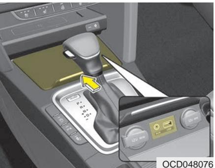
Порт AUX можно использовать для подключения аудиоустройства, а порт USB — для подключения устройства USB или iPod®.
