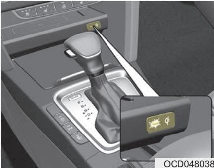
Система беспроводной зарядки смартфона находится в передней части центральной консоли.
