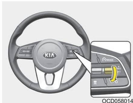
3. Переместите рычаг вниз (в положение «SET-») и отпустите на нужной скорости. На ЖК-дисплее появится установленная скорость и расстояние вашего автомобиля до другого транспортного средства.
