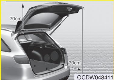
При открытии двери багажного отделения с электроприводом (двери багажного отделения с интеллектуальным управлением) убедитесь в отсутствии посторонних предметов и людей в непосредственной близости от задней части автомобиля. В противном случае это может привести к травмам или повреждениям автомобиля или окружающих предметов.
