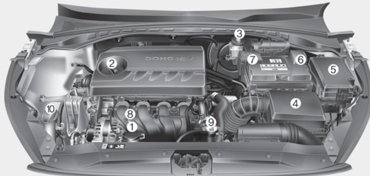
1. Бачок с охлаждающей жидкостью двигателя
