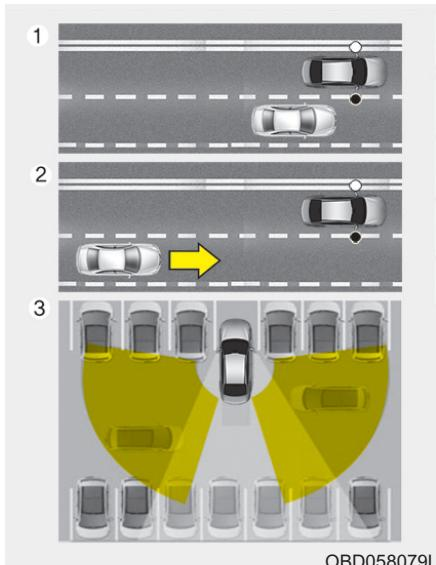
Система предупреждения об опасности столкновения в непросматриваемой зоне (BCW) использует радарный датчик для предупреждения водителя во время движения.
