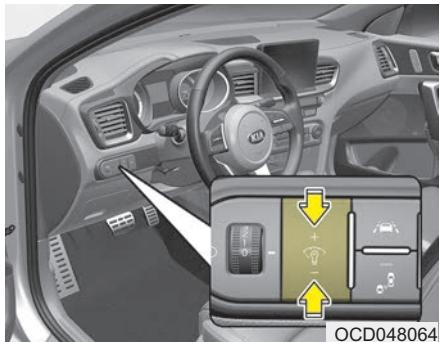
Яркость подсветки приборной панели регулируется при помощи кнопки управления подсветкой (+ или -), когда ключ зажигания или кнопка «Engine Start/Stop» (Запуска/остановки двигателя) установлены в положение «ON» или включены задние фары.
