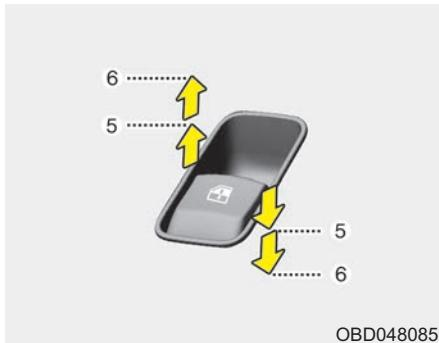
При кратковременном нажатии на переключатель стеклоподъемника или его оттягивании до второго положения фиксации (6) окно полностью опускается или поднимается, даже если переключатель отпущен. Для того чтобы остановить окно в нужном положении при работающем стеклоподъемнике, нажмите на переключатель или оттяните его (в направлении обратном движению), а затем отпустите.
