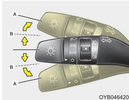
Указатели поворота работают только при включенном зажигании. Для включения указателей поворота переместите рычаг вверх или вниз (A). При включении указателя поворота на приборной панели загорается зеленая стрелка, которая автоматически выключается после выполнения поворота.
