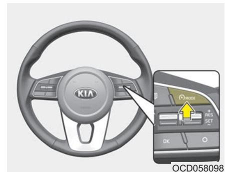
1. Чтобы включить систему, нажмите кнопку MODE на руле. Загорится индикатор круиз-контроля. Отобразится заданная скорость.
