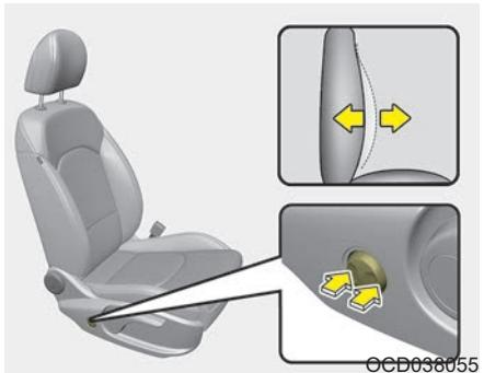
Поясничную опору можно регулировать путем нажатия на ее переключатель сбоку от сиденья.
