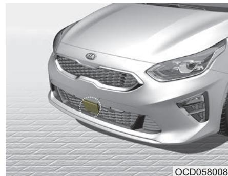
Этот датчик определяет расстояние до впереди идущего автомобиля. Если он покрыт грязью или посторонними веществами, то в работе системы определения расстояния между автомобилями возможны ошибки.
