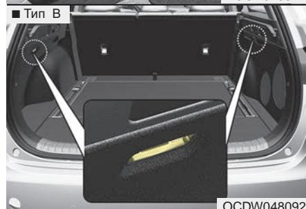
Лампа подсветки багажного отделения загорается при открывании багажника (двери багажного отделения).
