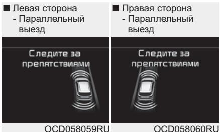
При выезде с парковочного места функция помощи при парковке проверяет пространство перед автомобилем и позади него.
