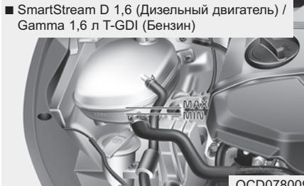
Проверьте состояние и соединения всех шлангов систем охлаждения и обогрева. Замените все вздутые или изношенные шланги.
