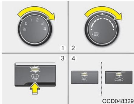
1. Установите максимальную скорость вентилятора (крайнее правое положение регулятора).
