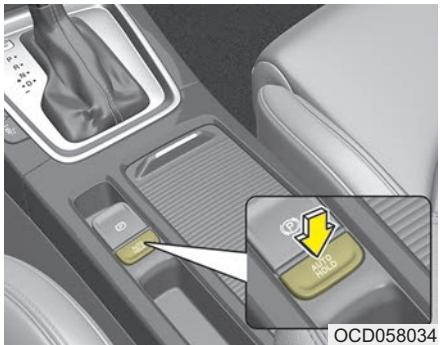
Для отключения функции автоматического удержания нажмите соответствующий переключатель. Индикатор «AUTO HOLD» (Автоматическое удержание) гаснет.
