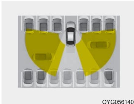
При выезде автомобиля задним ходом с парковочного места датчик определяет наличие автомобилей, приближающихся слева и справа, и передает водителю соответствующую информацию.
