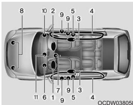
Система пассивной безопасности состоит из следующих компонентов:
