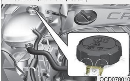
2. Убедитесь, что небольшие выступы внутри крышки заливной горловины охлаждающей жидкости надежно зафиксированы.
