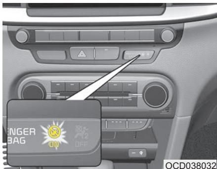
Индикаторная лампа включения фронтальной подушки безопасности пассажира загорается приблизительно на 4 секунды после поворота замка зажигания в положение «ON» (Вкл.).
