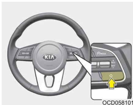
Каждое из этих действий отменит работу системы круиз-контроля (индикаторная лампа круиз-контроля погаснет), но система при этом не будет выключена. При желании вы сможете возобновить работу системы круиз-контроля, переведя вверх (к «RES+») рычаг, расположенный на рулевом колесе. Система вернется к установленной скорости.
