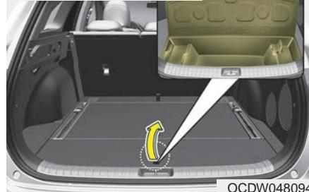
Здесь можно хранить аптечку, знак аварийной остановки (передний лоток), инструменты и др.
