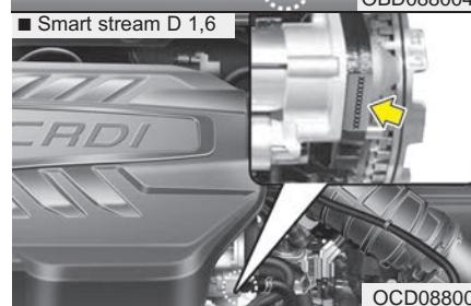
Номер двигателя выбит на блоке цилиндров, как показано на иллюстрации.
