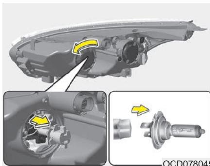
6. Установите в узел фары новый патрон, совместив выступы на патроне с прорезями на узле фары. Вдавите патрон в узел фары, после чего поверните патрон по часовой стрелке.
