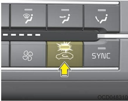
С помощью этого регулятора можно выбрать забор наружного (свежего) воздуха или режима рециркуляции. Чтобы изменить режим забора воздуха, нажмите кнопку управления.
