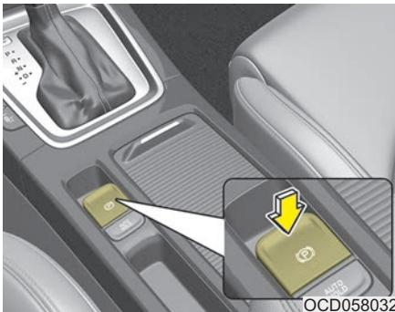
Для того чтобы отключить EPB (электронный стояночный тормоз), нажмите на переключатель EPB при соблюдении следующих условий:
