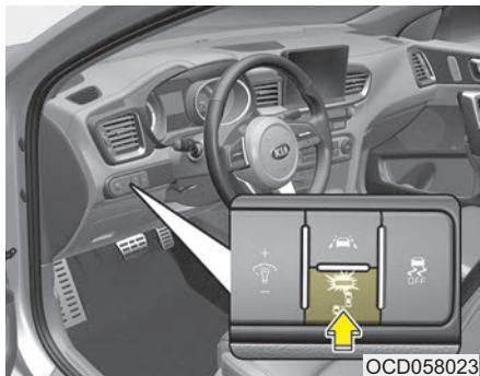
Индикатор на переключателе загорается, если нажать переключатель системы предупреждения об опасности столкновения в непросматриваемой зоне (BCW), когда замок зажигания находится в положении «ON» (Вкл.). Система активируется, если скорость автомобиля превышает 30 км/ч. Если снова нажать на переключатель, индикатор на переключателе и система будут отключены.
