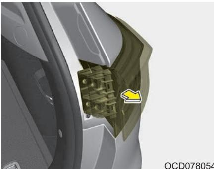
4. Извлеките узел задней комбинированной фары из кузова автомобиля.
