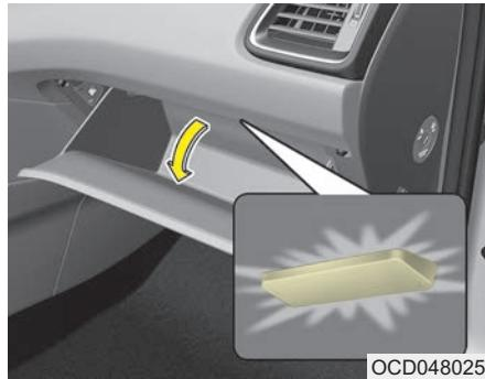
Лампа освещения перчаточного ящика загорается при его открытии.
