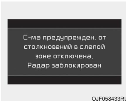
Сообщение появляется, чтобы уведомить водителя о наличии посторонних предметов на заднем бампере (сверху/внутри) или о повышенной температуре рядом с задним бампером. Лампа на переключателе и система выключаются автоматически.
