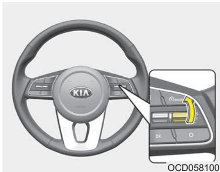
Если для отмены скорости круиз-контроля использовался какой-либо иной метод, кроме кнопки круиз-контроля **MODE**, и система по-прежнему работает, то при перемещении рычага верх (в положение **RES+**) скорость круиз-контроля будет возобновлена.
