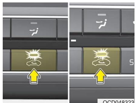
С помощью регулятора забора свежего воздуха можно выбрать забор наружного (свежего) воздуха или режима рециркуляции.
