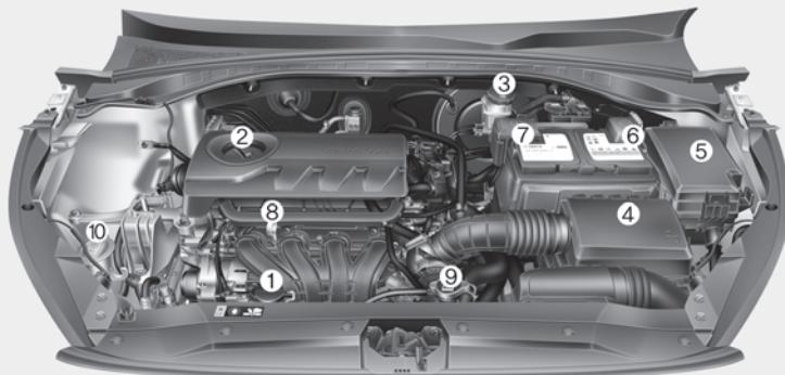
1. Бачок с охлаждающей жидкостью двигателя
