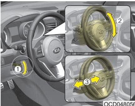
Для изменения угла наклона рулевого колеса потяните вниз отжимной рычаг фиксатора (1), установите рулевое колесо под нужным углом (2) и на нужной высоте (3, при наличии), затем потяните отжимной рычаг фиксатора вверх, благодаря чему рулевое колесо фиксируется в заданном положении. Выполните регулировку положения рулевого колеса перед началом движения.
