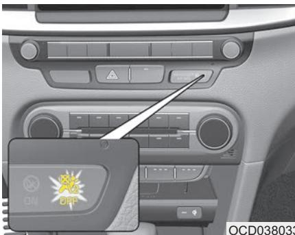
Сигнальная лампа выключения фронтальной подушки безопасности пассажира горит около 4 секунд после поворота переключателя зажигания в положение «ON» (Вкл.).
