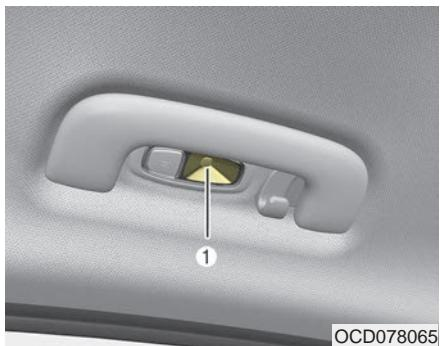
Если лампа личного освещения (светодиодная) (1) не работает, следует проверить автомобиль в специализированной мастерской.
