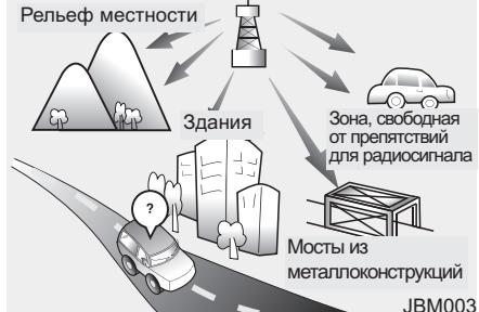
Прием радиосигналов в диапазоне АМ возможен на большем расстоянии по сравнению с радиосигналами в диапазоне FM. Это связано с тем, что АМ-радиоволны передаются на низких частотах. Это длинные низкочастотные радиоволны следуют за изогнутым профилем земной поверхности, а не передаются напрямую. Кроме того, они обходят препятствия, что обеспечивает увеличение зоны охвата.
