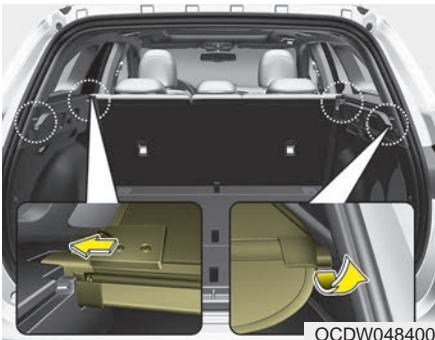
С помощью защитного экрана для груза можно закрыть вещи, которые находятся в багажнике.
