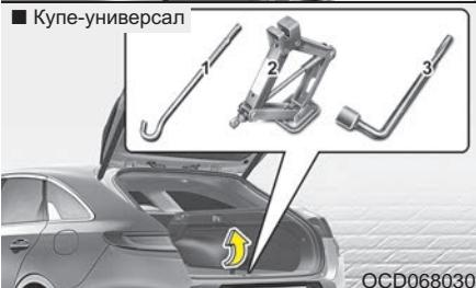
Домкрат, рукоятка домкрата и колесный гаечный ключ хранятся в багажном отсеке.
