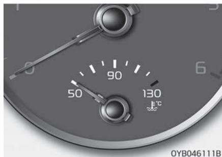
Этот индикатор показывает температуру охлаждающей жидкости двигателя, когда замок зажигания или кнопка «ENGINE START/STOP» (Запуска/остановки двигателя) находятся в положении «ON» (Вкл.).
