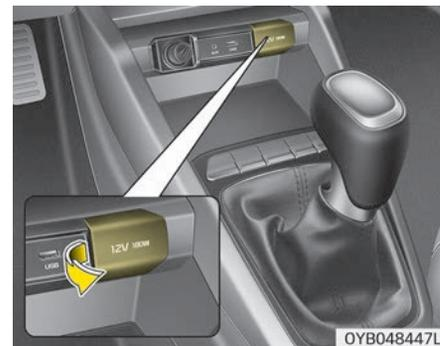
Розетка предназначена для подключения мобильных телефонов и других электроприборов, рассчитанных на питание от автомобильной электросистемы. Эти электроприборы должны потреблять ток не более 10 А при включенном двигателе.
