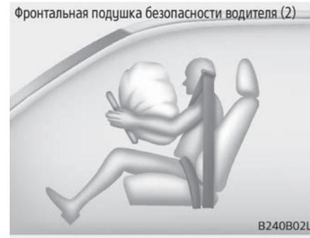
Когда срабатывают подушки безопасности, под давлением от их разворачивания отделяются отрывные швы в предохранительных крышках. После открывания крышки подушка безопасности полностью надувается.
