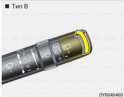
Если отодвинуть рычаг от себя и дважды переместить переключатель стеклоочистителей в верхнее положение, будет разбрызгана жидкость для заднего стеклоомывателя, а задние стеклоочистители сделают 1–3 цикла. Разбрызгивание и работа стеклоочистителя будут продолжаться, пока вы не отпустите рычаг.
