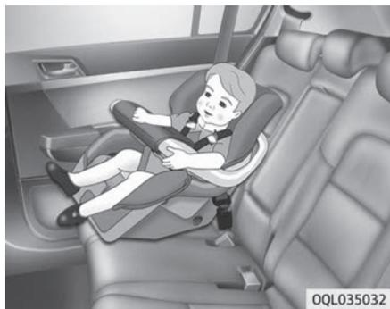
Детское автокресло с ориентацией по ходу движения обеспечивает фиксацию ребенка при помощи ремней. Перевозить ребенка в детском автокресле с ориентацией по ходу движения, снабженном ремнями, следует до тех пор, пока рост и вес ребенка не достигли ограничений, установленных производителем детского автокресла. Когда ребенок вырастает из детского автокресла с ориентацией по ходу движения, его следует перевозить на дополнительной подушке.
