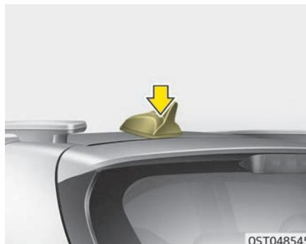
Прием и передачу данных будет осуществлять антенна типа «акулий плавник».
