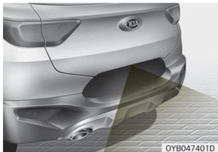
Монитор заднего вида активируется при работающем двигателе, если рычаг переключения передач находится в положении «R» (задний ход). Данная система является вспомогательной и предназначена для вывода изображения обстановки позади движущегося задним ходом автомобиля на зеркало или монитор навигационной системы.
