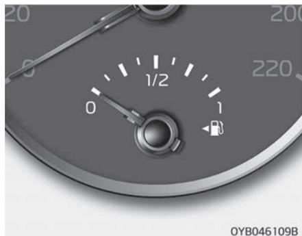
Указатель уровня топлива показывает примерное количество топлива, оставшегося в топливном баке.
