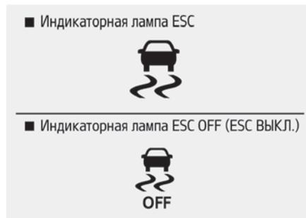
Когда ключ зажигания повернут в положение «ON» (Вкл.), индикаторная лампа загорается, а потом гаснет, если система электронного контроля устойчивости (ESC) работает нормально.
