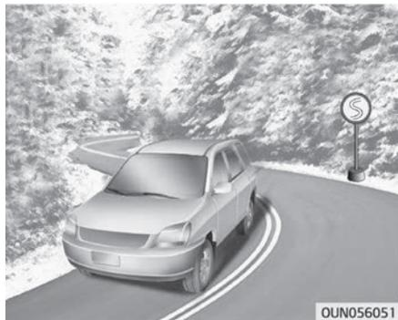
Избегайте торможения или переключения передач на поворотах, особенно при мокрой поверхности дороги. Повороты желательно преодолевать с плавным ускорением. Если следовать этой рекомендации, износ шин будет сведен к минимуму.
