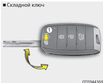
Чтобы разложить ключ, нажмите кнопку фиксатора. Ключ разложится автоматически. Складывание ключа выполняется вручную, одновременно нажимая кнопку фиксатора.
