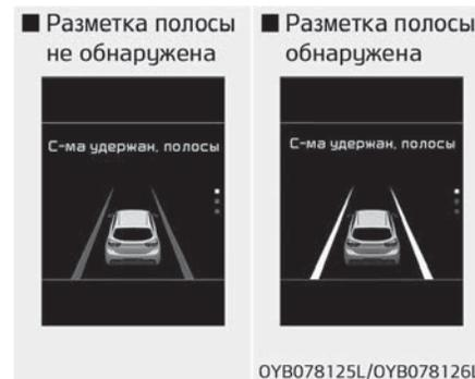
Если скорость автомобиля превышает 60 км/ч и система распознает линии разметки, цвет меняется с серого на белый.
