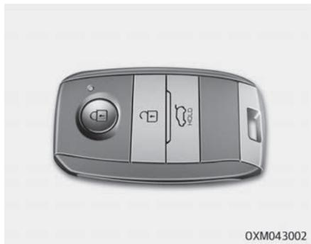
С помощью интеллектуального ключа можно запереть или отпереть любую дверь (в том числе дверь багажного отделения) и даже запустить двигатель, не вставляя ключ в замок зажигания. Назначение кнопок на интеллектуальном ключе такое же, как и для складного ключа.
