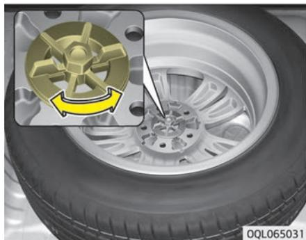
Поверните болт крепления шины против часовой стрелки. Закрепление для хранения выполняется в порядке, обратном снятию. Храните запасное колесо и инструменты надлежащим образом, чтобы они не гремели во время движения автомобиля.
