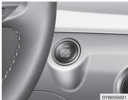
Кнопка «ENGINE START/STOP» (запуска/остановки двигателя) подсвечивается при каждом открывании передней двери. Подсветка гаснет примерно через 30 секунд после закрывания двери. Она также гаснет сразу же при срабатывании системы противоугонной сигнализации.
