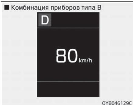
В этом режиме отображается текущая скорость автомобиля.
