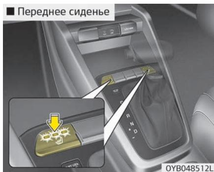
Предусмотрен подогрев передних сидений в холодную погоду. Переместите замок зажигания в положение «ON» (Вкл.), нажмите один из переключателей для включения подогрева сиденья водителя или переднего пассажира.
