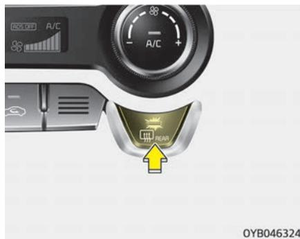
Обогреватель заднего стекла предназначен для обогрева и удаления запотевания, инея или тонкого слоя льда с заднего стекла. Обогреватель работает при включенном двигателе.
