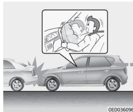
Фронтальные подушки безопасности предназначены для надувания при лобовом столкновении в зависимости от интенсивности, скорости или угла удара.
