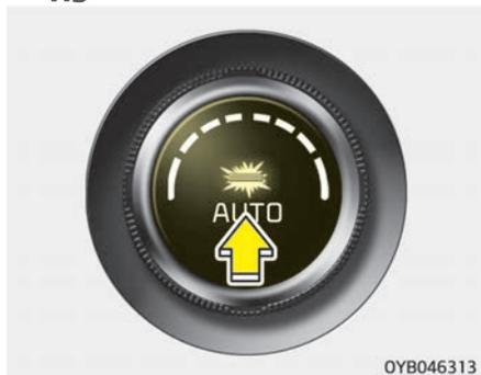
1. Нажмите кнопку «АВТО» (Автоматический режим). Управление режимами работы, скоростью вращения вентилятора, режимом подачи воздуха и работой системы кондиционирования будет осуществляться автоматически в соответствии с заданным значением температуры.
