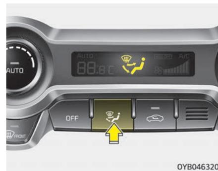
Кнопка выбора режима управляет направлением потока воздуха через вентиляционную систему. Подача воздуха осуществляется через следующие отверстия:
