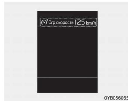
Для превышения заданного ограничения скорости нужно сильно нажать на педаль газа (утопив ее более чем на 80 %) до срабатывания механизма переключения на низкую передачу, при этом послышится щелчок. На дисплее начинает мигать заданное значение ограничения скорости, а также подается звуковой сигнал; звуковой сигнал будет работать до возврата скорости автомобиля в заданные пределы.
