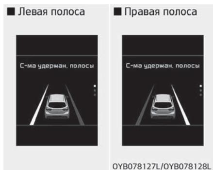
Если автомобиль выезжает за пределы полосы движения, линия разметки полосы, которую вы пересекаете, начнет мигать на ЖК-дисплее и прозвучит звуковой сигнал.
