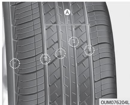
При равномерном износе шины становится виден индикатор износа (A), имеющий вид сплошной полосы. Это значит, что оставшаяся толщина протектора на шине составляет менее 1,6 мм. В этом случае замените шину. Для замены шины не дожидайтесь проявления индикатора износа по всему протектору.
