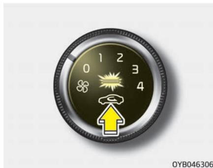
С помощью регулятора забора свежего воздуха можно выбрать забор наружного (свежего) воздуха или режима рециркуляции. Чтобы изменить режим забора воздуха, нажмите кнопку управления.
