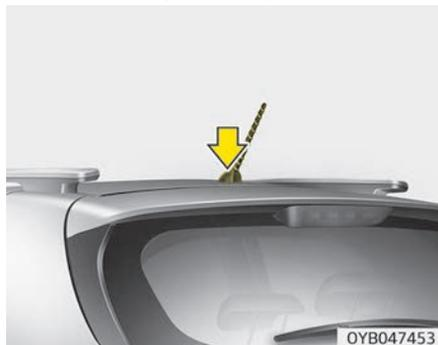
Ваш автомобиль оснащен антенной на крыше для приема сигналов радиостанций на частотах AM и FM. Антенна является съемной.
