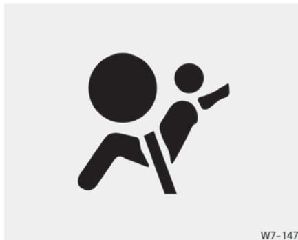
Сигнальная лампа неисправности подушки безопасности на приборной панели автомобиля призвана предупреждать о потенциальной проблеме с подушкой безопасности (системой пассивной безопасности).
