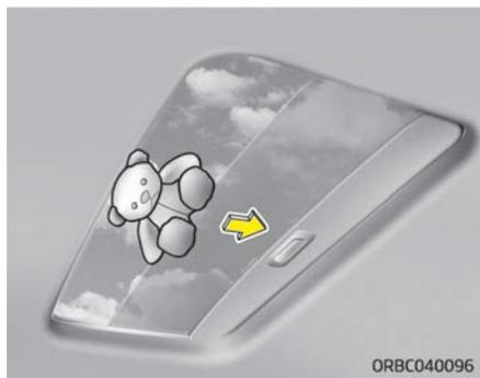
Если в ходе автоматического закрытия люка в крыше будет обнаружен какой-либо объект или часть тела, система изменит направление на обратное, а затем остановит движение.
