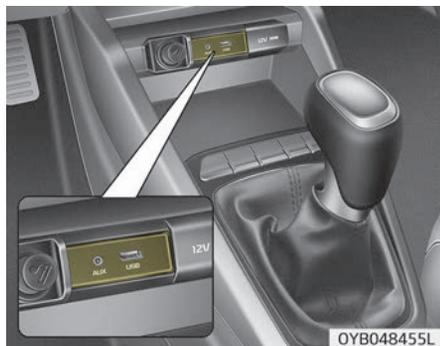
Порт AUX можно использовать для подключения аудиоустройств, а порт USB — для подключения устройства USB или iPod®.
