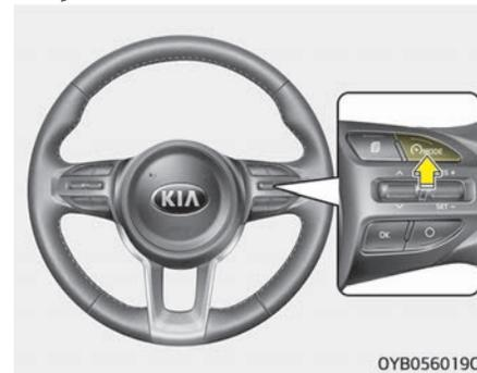
1. Чтобы включить систему, дважды нажмите кнопку ограничителя скорости
