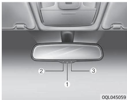
Электрическое зеркало заднего вида автоматически убирает ослепляющий свет фар позади идущих транспортных средств в ночное время или в условиях низкой освещенности. Датчик (3), установленный в зеркале, определяет уровень освещенности вокруг автомобиля и автоматически убирает ослепляющий свет фар позади идущих автомобилей.
