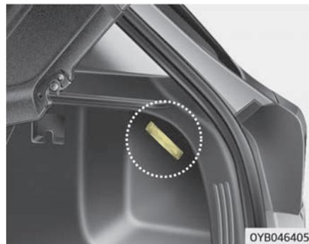
Лампа подсветки багажного отделения загорается при открывании багажника (двери багажного отделения).
