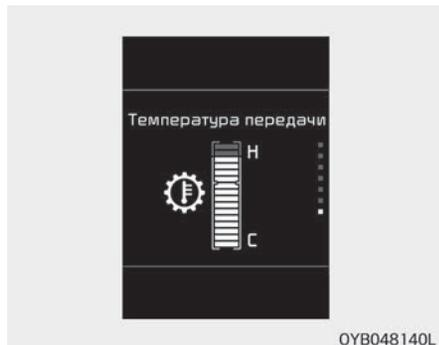
В данном режиме отображается температура трансмиссии с двойным сцеплением.
