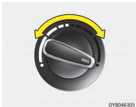
Регулятор температуры позволяет контролировать температуру воздуха, поступающего из вентиляционной системы. Для изменения температуры воздуха в салоне поверните регулятор вправо, чтоб сделать воздух теплее, или влево, чтобы сделать его холоднее.
