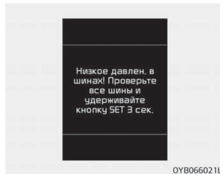
При наличии полуспушенной шины загорается сигнальная лампа (Ш). Вышеуказанное сообщение может отображаться на комбинации приборов определенного типа.
