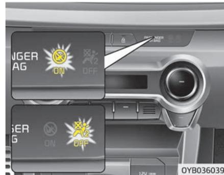
Для того чтобы отключить фронтальную подушку безопасности пассажира, вставьте мастер-ключ в выключатель фронтальной подушки безопасности и переместите его в положение «OFF» (Выкл.). Загорится индикатор отключения фронтальной подушки безопасности пассажира (☀), который будет гореть все время, пока не будет снова включена фронтальная подушка безопасности.
