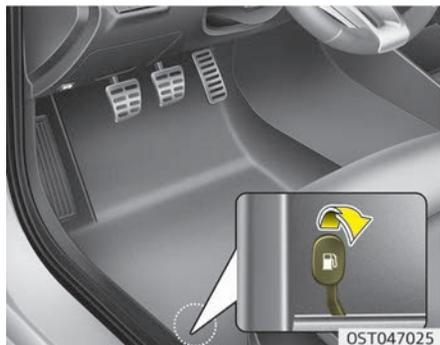
Лючок горловины топливного бака следует открывать изнутри автомобиля, потянув ручку открытия лючка горловины топливного бака, расположенную на полу возле водительского сиденья.
