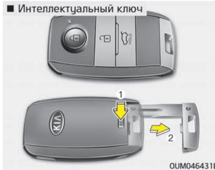
Чтобы извлечь механический ключ, нажмите и удерживайте кнопку разблокировки и извлеките механический ключ. Чтобы снова вставить механический ключ, поместите ключ в скважину и нажмите на него до щелчка.
