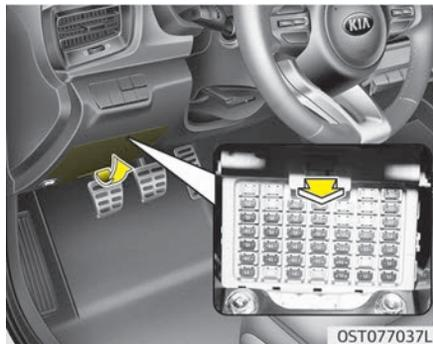
Автомобиль оснащен предохранителем памяти, предотвращающим разрядку аккумулятора, если автомобиль находится на стоянке и не эксплуатируется в течение длительного времени. Прежде чем припарковать автомобиль на длительное время, выполните следующие процедуры.
