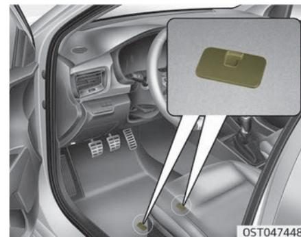
При использовании напольного коврика на напольном покрытии под передним креслом закрепите его при помощи специального (-ых) фиксатора (-ов). Это позволит предотвратить соскальзывание коврика вперед.
