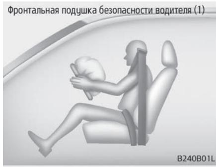
Модули подушек безопасности располагаются по центру рулевого колеса и в передней панели над перчаточным ящиком, напротив пассажира. Если модуль SRSCM регистрирует сильный удар в переднюю часть автомобиля, то автоматически срабатывают подушки безопасности.
