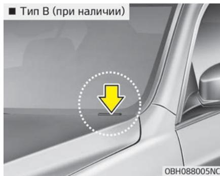
Номер VIN также указан на табличке, прикрепленной к верхней части приборной панели. Номер на табличке можно легко разглядеть снаружи через лобовое стекло.
