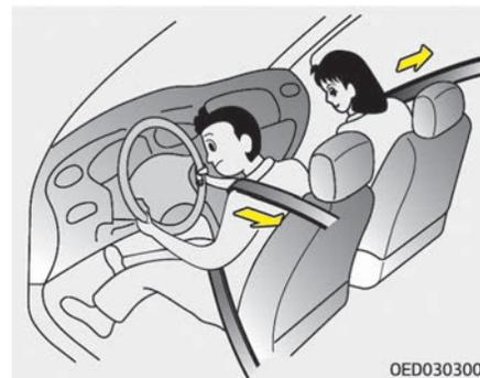
Ваш автомобиль оборудован преднатяжителями ремней безопасности для передних и задних боковых сидений. Преднатяжитель служит для плотного притягивания поясного ремня безопасности к телу человека в случае лобового столкновения. Преднатяжители ремней безопасности срабатывают в случае достаточно сильного столкновения.
