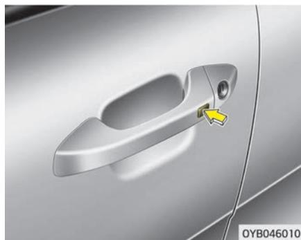
Имея при себе интеллектуальный ключ, вы можете запирать и отпирать двери автомобиля (включая дверь багажного отделения). С его помощью можно также запустить двигатель. Подробнее см. далее.
