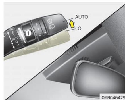
Датчика дождя, расположенный на верхней части лобового стекла, определяет количество осадков и регулирует интервал цикла очистки стекла. Чем сильнее становится дождь, тем быстрее работает стеклоочиститель. Когда дождь прекращается, стеклоочиститель останавливается. Для изменения скорости его работы поверните регулятор скорости (1).
