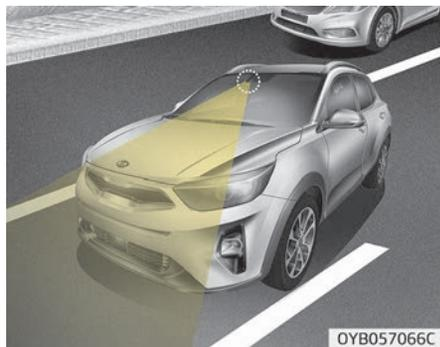
Система удержания полосы (LKA) определяет дорожную разметку с помощью камеры фронтального обзора, расположенной на ветровом стекле, и помогает водителю в рулевом управлении, чтобы удержать автомобиль на полосе.
