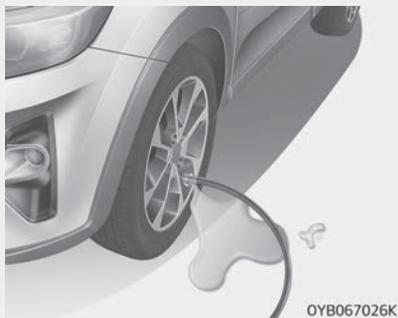
**Надежно подсоедините шланг для заливки герметика к клапану. В противном случае герметик может потечь обратно и засорить шланг для заливки.**
