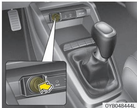
Для использования прикуривателя ключ зажигания должен находиться в положении «ACC» или «ON».
