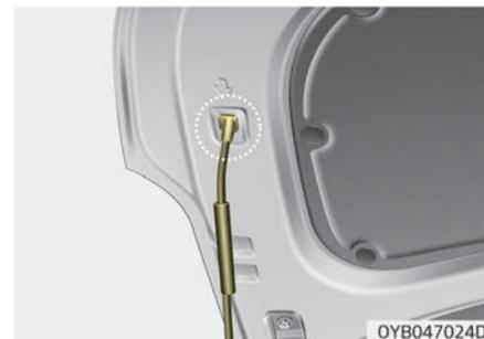
3. Извлеките опорную стойку, расположенную внутри капота.
