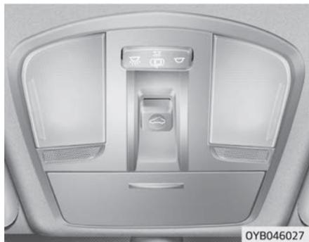
Если ваш автомобиль оснащен люком в крыше, его можно открыть или приоткрыть при помощи рычага управления люком, который находится на потолочной консоли.
