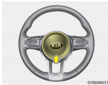
Чтобы подать звуковой сигнал, нажмите на символы гудка на рулевом колесе. Регулярно проверяйте звуковой сигнал, чтобы убедиться в его исправной работе.
