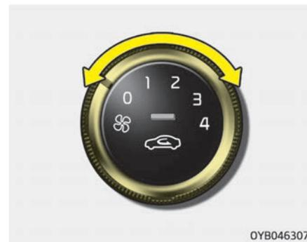
Для того чтобы вентилятор работал, замок зажигания должен находиться в положении «ON» (Вкл.).
