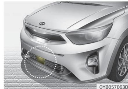
Датчик необходим для поддержания безопасного расстояния от впереди идущего автомобиля. Тем не менее, загрязненный посторонними веществами объектив датчика, такими как снег и дождь, отрицательно влияет на работу системы. При такой ситуации система FCA может быть временно отключена. Регулярно протирайте объектив датчика.
